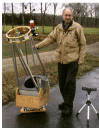
Ezen a képen Nils Olof Carlin látható házi készítésű, hordozható, 33 cm-es, csővázaz Dobson-reflektorával. Kezdetől fogva csak a főtükör ugyanaz, de ez a távcső volt Carlin első távcső-készítő projektje – azóta sokszor módosítva lett. (Kép: Nils Olof Carlin)
