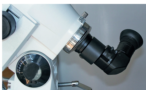
Amici Prisma mit zuschaltbarer Zusatzvergrößerung für alle Polarscope
