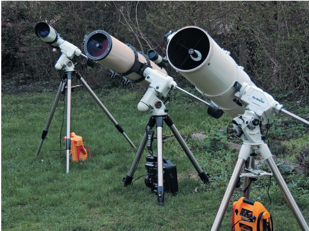
MONTIERUNGEN IM TEST: HEQ5 PRO (MIT 130MM APO), NEQ6 (MIT 200MM MN), AZ-EQ6 (MIT 250MM NEWTON).
