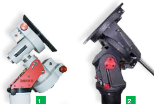
Fornax Serie [1] Diese Montierung erfüllt voll die anspruchsvollen Bedingungen der Astrofotografie und hat bis zu 50 kg (bzw. 100 und 130 kg) Tragfähigkeit. Die Montierung besteht ausschließlich aus rostfreiem Metall, das Schneckengehäuse ist staub- und wasserdicht. Deshalb bleiben die Schneckenräder immer sauber und gut gefettet, und die Fornax Serie besitzt eine entsprechende hohe Lebensdauer. 4200 € (F51) 6800 € (F100) 8900 € (F150) 900 € (FS2 STEUERUNG) 630 € (UMI-FORNAX STEUERUNG)
