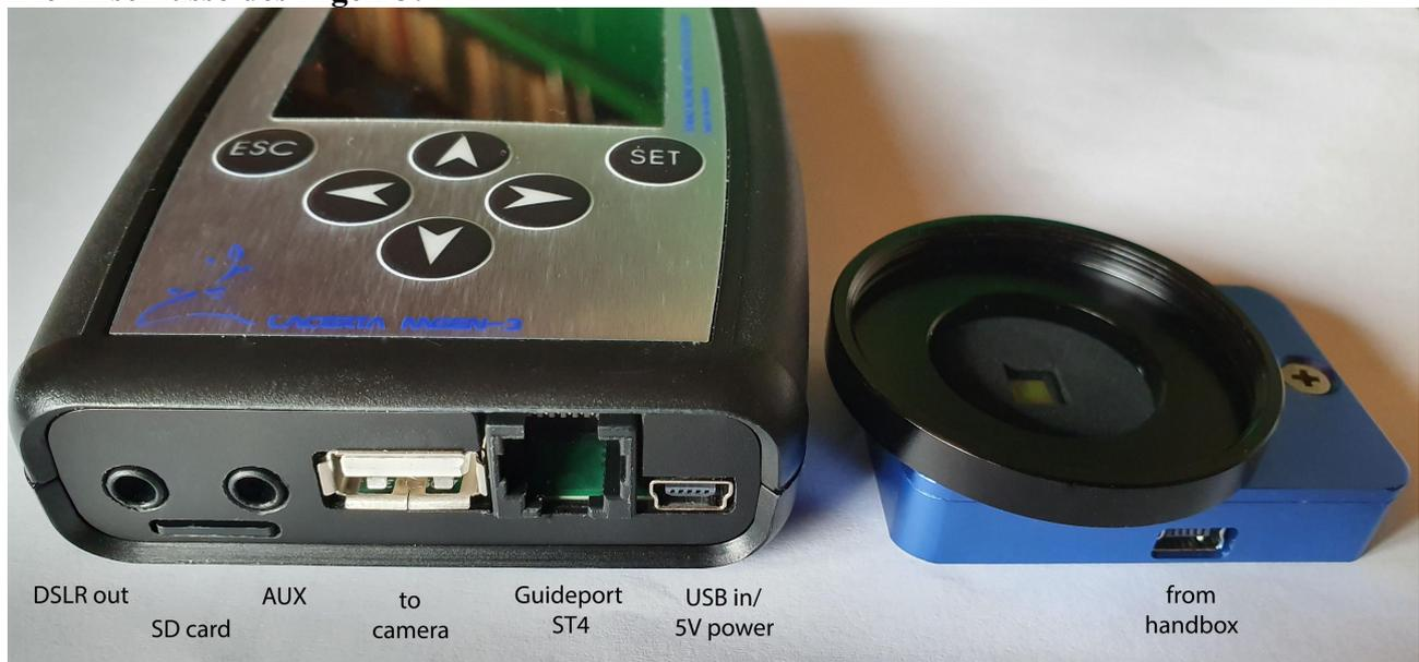
**Stromversorgung:** Der Mgen-3 wird über die USB Buchse rechts unten an der Handbox mit Strom versorgt (siehe Bild). Sie können ein handelsübliches USB Netzteil (z.B. für Handy), eine Powerbank mit USB Anschluss oder einen USB Port am PC/Laptop verwenden. Die Stromaufnahme ist ca. 240mA/1,2W.
