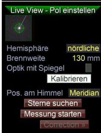
Der Mgen3 zeichnet danach eine kleine Linie vom Multistern weggehend, welche in Richtung des sichtbaren Poles zeigt. Der Mgen3 kennt nun die Ausrichtung der Montierungsachsen zur Kamera.
