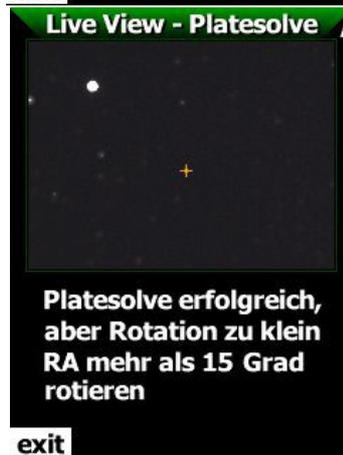
Die Position des Pols ist nun gespeichert, nun muss die Position der RA Achse der Montierung am Himmel bestimmt werden. Dazu drehen Sie RA Achse um mindestens 15 Grad. Achten Sie darauf, dass Sie DEC nicht berühren.
