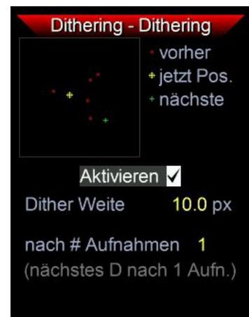
Es ist empfehlenswert, Dithern immer aktiviert zu haben. Die Dither Weite kann bis 99,9 Pixel erhöht werden. In der Praxis reichen Werte um 10-15 Pixel für den Effekt. Die Mgen-3 Kamera hat Pixelgröße 3.75µm und z.B. mit einem Verhältnis von Aufnahme zu Guiding Brennweite von 5:1 wäre das ein Versatz von 50-75 Pixel auf einer Kamera mit derselben Pixelgröße. Bei sehr kleinen Aufnahmebrennweiten kann man den Wert erhöhen, aber das Dithern dauert dann auch länger.
