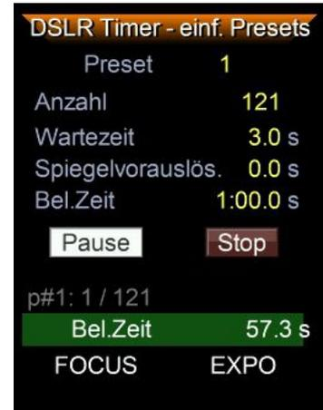
Die Belichtungsreihe kann pausiert und fortgesetzt werden. Beim Fokus Signal leuchtet die ESC Taste auf und beim Shutter Signal auch die SET Taste. Wenn Sie eine Spiegelvorauslösung verwenden wollen, muss die auch in der DSLR aktiviert werden. Beim Wert 0.0s wird keine Spiegelvorauslösung vorgenommen.
