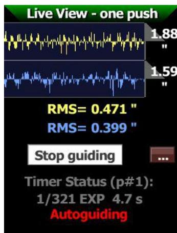
Der Mgen-3 beginnt mit der **Sternsuche**, identifiziert und wählt mehrere geeignete Sterne aus, führt danach die **Kalibration** mit der Montierung (welche bereits nachführen muss!) durch, und startet dann automatisch das **Autoguiding**. Der Timer Status wird hier auch angezeigt.
