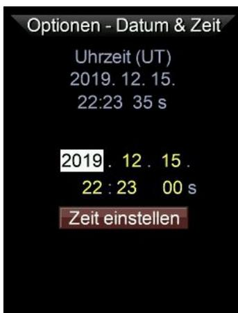
Der Mgen-3 verfügt über eine Echtzeituhr, welche auch nach dem Abschalten weiterläuft und durch eine innere Batterie (CR2032) versorgt wird. Sie befindet sich auf der Rückseite der Platine, welche zum Tausch herausgenommen werden kann.
