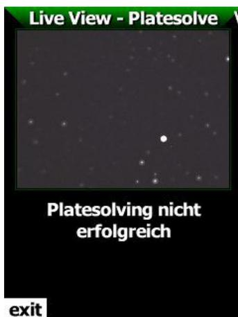
**Bemerkung:** Während Sie das Guidescope bewegen, laufen die Belichtungen ständig weiter und die Sterne werden verschmiert. Diese Anzeige sagt Ihnen, dass das aktuelle Bild nicht astrometriert werden konnte. Warten Sie einfach eine Sekunde, bis das nächste Bild kommt und verarbeitet wird. Diese Meldung erscheint auch, wenn das Guidescope nicht auf den Bereich gerichtet ist, der von den Sterndaten abgedeckt wird.
