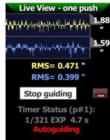
Das Live Bild wechselt zum Guidegraphen, rechts wird die Skalierung der Y Achse und darunter die Standardabweichung rms angezeigt. Hier kann auch das Guiding gestoppt und wieder fortgesetzt werden. Wird das Teleskop zu einem neuen Feld geschwenkt, erfolgt vor dem Fortsetzen automatisch eine neue Sternsuche und Kalibration. Bei Bedarf kann die Kalibration durch eine vorhergehende manuelle Sternsuche von hier aus getriggert werden.
