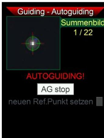
Wird das Autoguiding gestartet, erscheint der rote Schriftzug **AUTOGUIDING** blinkend unter dem Bild, und ein rotes Fadenkreuz markiert den Punkt an dem der Stern aktuell gehalten wird.
