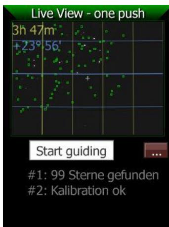
Das Platesolving erfolgt unabhängig vom Guiding im Hintergrund und beeinflusst dieses nicht. Das Markieren der Sterne bei der für das Guiding wichtigen Sternsuche ist ebenfalls eine unabhängige Funktion.
