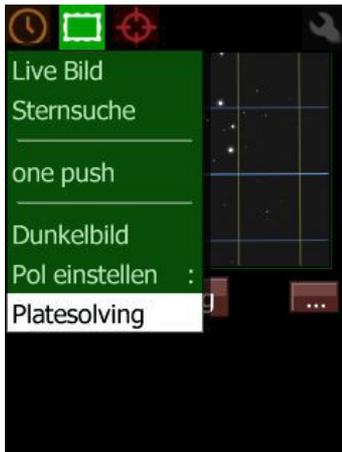
Hier können mit den Richtungstasten **UP** und **DOWN** Einträge ausgewählt werden, mit den Tasten **LEFT** und **RIGHT** können auch Menüstränge gewechselt werden.
