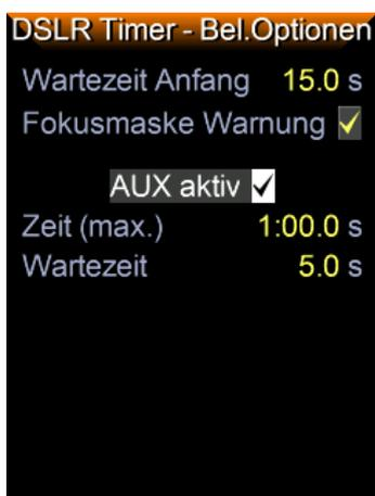
**Wartezeit Anfang** – nach dem Auslösen der Start Funktion verstreicht die hier eingegebene Wartezeit, bevor die erste Belichtung der Sequenz ausgelöst wird. Nützlich, wenn man zB auf einem instabilen Balkon fotografiert, und Zeit braucht um sich zu entfernen. Max. 25s.
