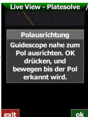
Starten Sie die Ausrichtung und folgen Sie den Anweisungen auf dem Display: "Guidescope nahe zum Pol ausrichten.. etc" Das ist eventuell bereits bei der vorherigen Brennweitenmessung geschehen. Drücken Sie ok (**SET**), um fortzufahren.
