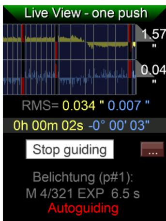
Der Status des Belichtungstimer wird praktischerweise auch auf dem **Onepush**-Bildschirm angezeigt. In der ersten Zeile sehen Sie das aktive Programm p#. Die Zeile darunter zeigt die Nummer der aktuellen Belichtung sowie die Gesamtzahl der Belichtungen, dann den Status (EXP = Belichtungszeit, W = Wartezeit, ML = Spiegelvorauslösung) und schließlich die laufende Belichtungszeit.
