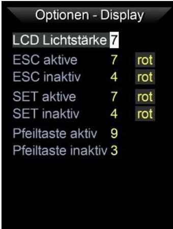
Einstellung der Leuchtstärken für Display und Tasten LEDs
