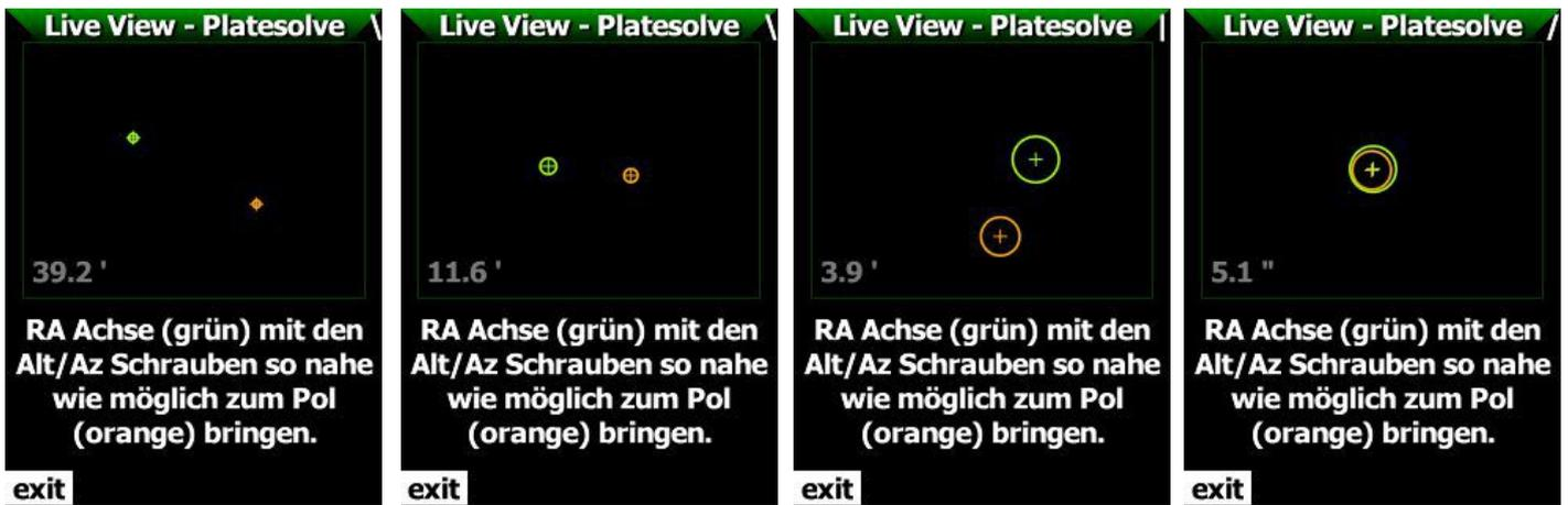
Wenn Sie die RA Achse in die Nähe des Pols bringen, wird die Ansicht automatisch eingezoomt und es erscheinen Kreise um die beiden Kreuze. Je kleiner der Abstand wird, desto geringer müssen die Korrekturen an den Alt/Az Schrauben sein. Eine Genauigkeit von weniger als 5arcmin ist für die Astrofotografie bei Verwendung eines Autoguiders völlig ausreichend, aber man kann ausprobieren, wie nah man herankommt. Mit **exit** beenden.
