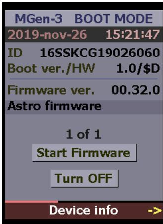
Am einfachsten ist das Updaten über einen **Windows PC**. Der Mgen Treiber muss installiert sein (FTDI Treiber, siehe Anfang der Anleitung). Schließen Sie den Mgen3 per USB an und betreten Sie den Boot Modus, um den Mgen-3 bereit zum Empfangen neuer Firmware zu machen. Die Kamera muss mit der Handbox verbunden sein.
