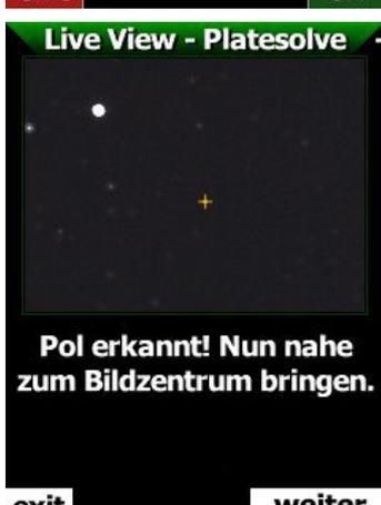
Immer wenn neue Bilder eintreffen, werden sie astrometriert und das Ergebnis angezeigt. Wird der Pol gefunden und ist innerhalb des Livebildes, wird er als oranges Kreuz angezeigt. Ist er außerhalb, zeigt eine Linie in seine Richtung, und die Entfernung vom Zentrum ist sichtbar. Richten Sie nun das Guidescope so aus, dass der Pol nahe zur Mitte kommt. Benutzen Sie zuerst die DEC, um zu minimieren. Drücken Sie **weiter**, um die Position des Poles zu speichern und weiterzugehen.
