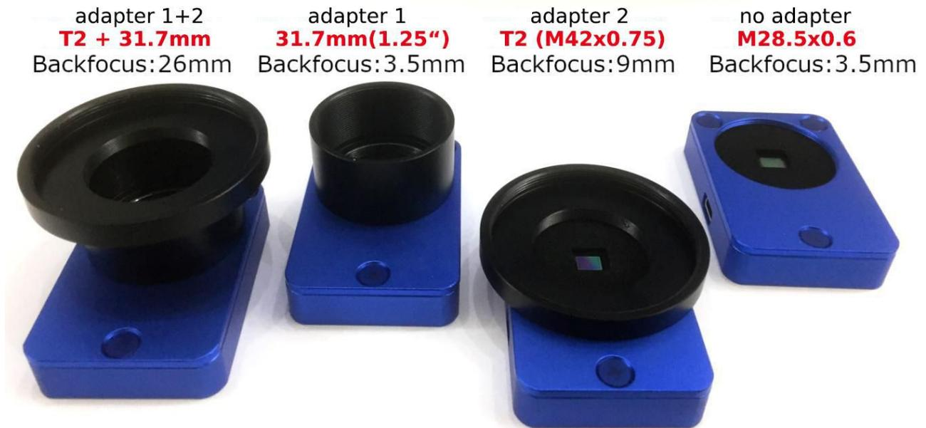
Die Kameraeinheit ist extrem leicht gebaut und wiegt nur etwa 40 Gramm. Der Anschluss an das Guidescop erfolgt über ein T2-Gewinde, eine 31.7mm Steckhülse oder durch das M28,5 Filtergewinde. Bei Verwendung des T2 Gewindes ist Mgen-3 mit MGEN-2 kompatibel (Backfocus: 9 mm)
