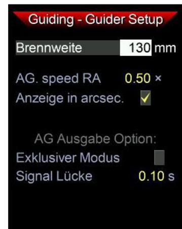
Die Werte kontrollieren bzw. die korrekten Werte eintragen. Der 50mm Sucher hat ca.180mm Brennweite, der 30mm Sucher ca.130mm, und der Skywatcher 50mm ED 242mm. Der Mgen kann die Brennweite auch messen, dazu am besten das Menü: Pol einstellen/Platesolving benutzen. Die Guide Geschwindigkeit ist in den meisten Fällen 0,50x Sternengeschwindigkeit.
