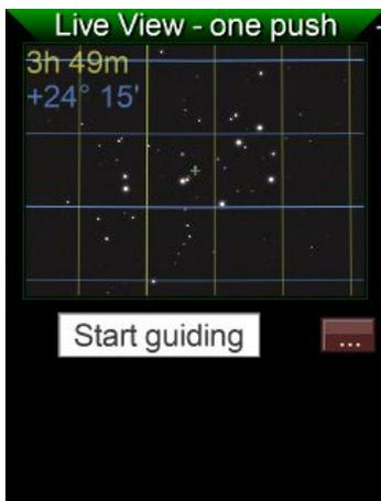
Durch einen kurzen Druck auf die ESC Taste wird der Mgen-3 eingeschaltet – nach dem Begrüßungsbild erscheint der **one push** Bildschirm. Hier zu sehen ist das live Bild mit den Sternen. Es ist ein schwarzweiß Bild, denn die Mgen-3 Kamera enthält einen sehr empfindlichen monochromen Sensor.
