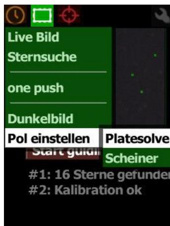
Der entsprechende Bildschirm ist mit der Scheiner-Methode gruppiert im Menü "Imaging", Untermenü "Polar alignment". Setzen Sie den Cursor auf Polar align und drücken Sie **SET**, um das Untermenü zu öffnen. Drücken Sie zum Aufrufen erneut **SET**.
