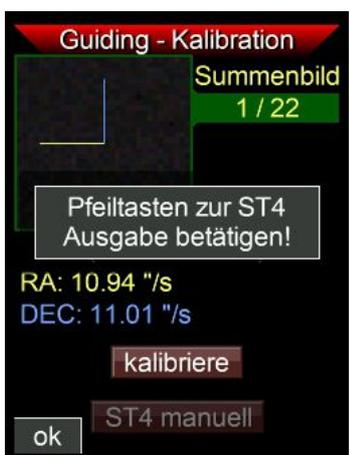
Unten am Bildschirm befindet sich die Schaltfläche “ST4 manuell”, sie ermöglicht es die ST4 Impulse manuell auszugeben. Eine sehr wichtige Möglichkeit, bei Problemen die Verbindung zur Montierung zu kontrollieren. Cursor darauf setzen und per SET bestätigen, es erscheint ein Kästchen mit dem Hinweis, dass nun die ST4 Signale durch Drücken der Pfeiltasten gesendet werden können. Sie sehen im kleinen Bild wie der Multistern reagiert.
