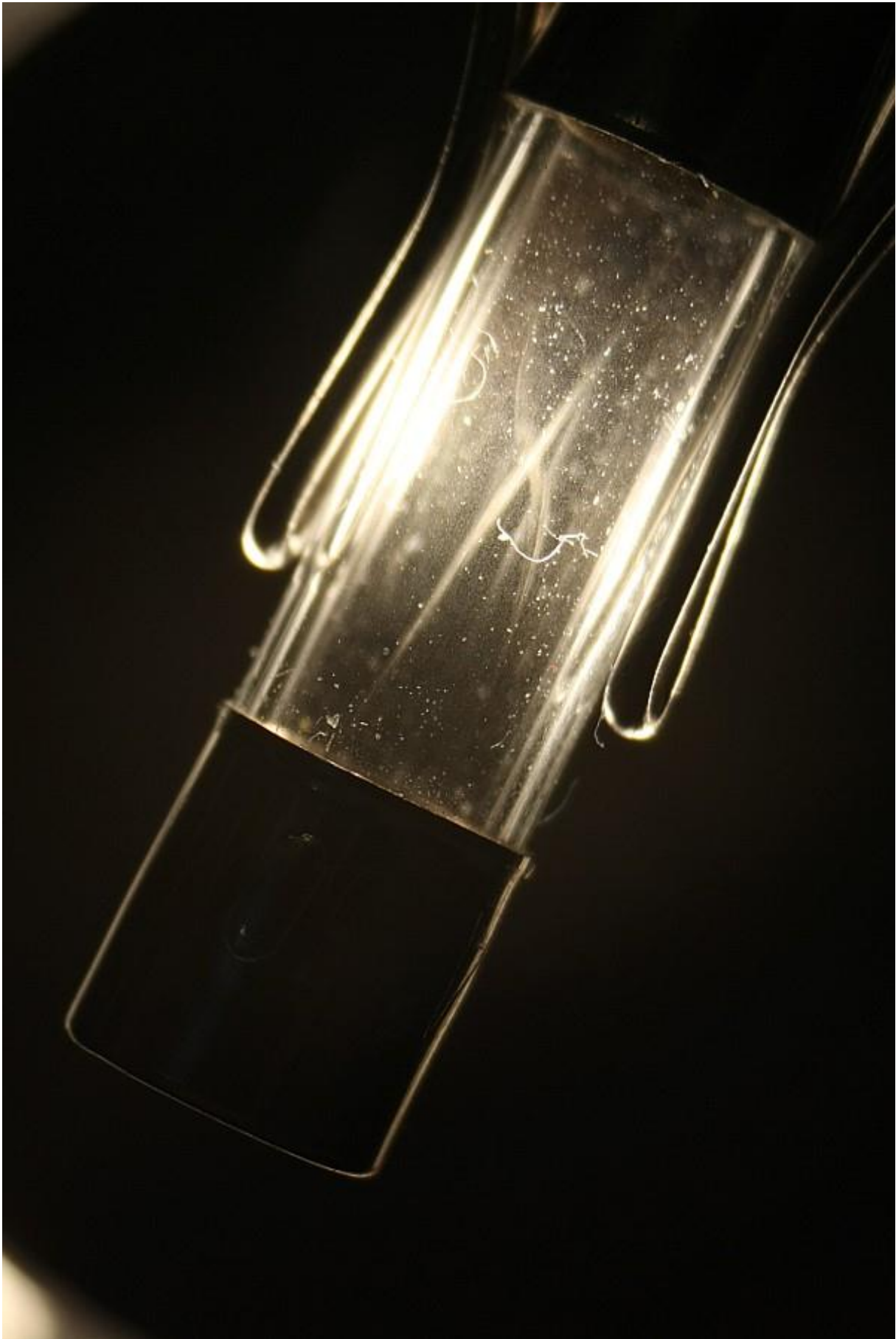
Sicherung im Dunkelfeld-Auflicht (Aufgenommen mit Lacerta GEM-4 Mikroskop)
