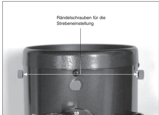
Abbildung 23. Um den Sekundärspiegel im Okularauszug des Fokussierers radial zu verschieben, drehen Sie an den beiden Rändelschrauben für die Strebeneinstellungen, die sich senkrecht zum Fokussierer befinden.
