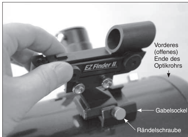
Abbildung 16. Setzen Sie das EZ Finder II-Reflexvisier wie abgebildet in den Gabelsockel ein.
