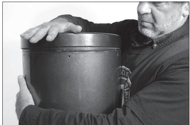
Abbildung 1.8. Umfassen Sie das Optikrohr, sodass Ihre Brust gegen die Ausbuchtung drückt, und klopfen Sie leicht auf die Spiegelzelle, bis sie komplett auf dem Optikrohr sitzt.
