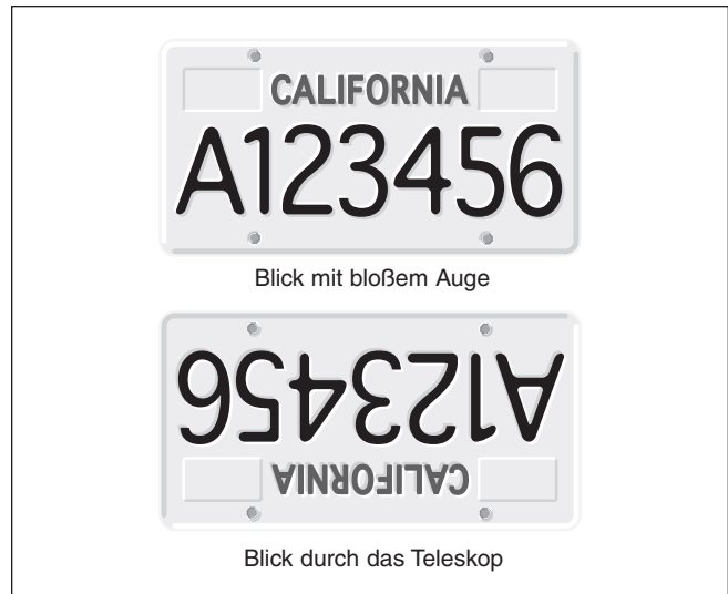
Abbildung 16. Beim Blick durch ein Spiegelteleskop steht das sichtbare Bild auf dem Kopf. Dies gilt auch für SkyQuest XT IntelliScope-Teleskope.
