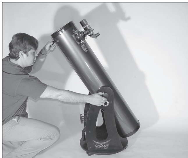
Abbildung 15. Passen Sie mit dem Einstellknopf die Vorspannung der Höheneinstellung so an, dass das Optiktrohr gut ausbalanciert ist. Das Optiktrohr sollte sich leicht leicht auf und ab bewegen lassen, ohne sich jedoch von selbst zu bewegen, wenn Sie es loslassen.
