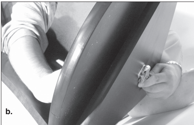
Abbildung 4. Achten Sie darauf, die Basisplatten zum Montieren nur leicht zu kippen, wie in der Abbildung gezeigt. Stellen Sie sie nicht auf die Seite. (a) Halten Sie die Kontermutter mit einem Schraubenschlüssel fest (b), während Sie die Schraube für die Azimut-Achse mit einem anderen Schraubenschlüssel drehen.
