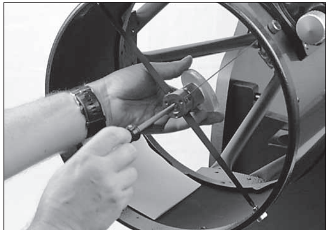
Abbildung 30. Zum Zentrieren des Sekundärspiegels unter dem Fokussierer halten Sie den Spiegelhalter mit einer Hand fest, während Sie die mittlere Schraube mit einem Kreuzschlitz-Schraubendreher justieren. Berühren Sie keinesfalls die Spiegeloberfläche!
