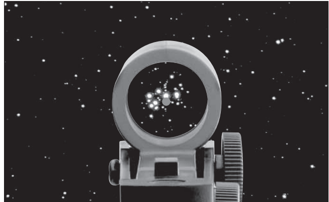
Abbildung 25. Das EZ Finder II-Reflexvisier zeigt mit einem winzigen roten Punkt am Himmel genau die Stelle an, auf die das Teleskop ausgerichtet ist.
