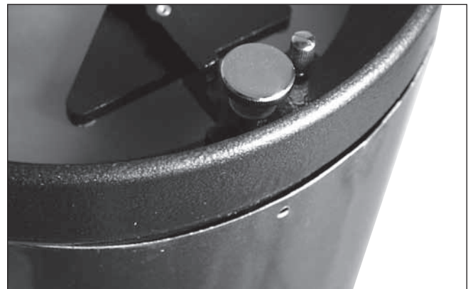
Abbildung 17. Suchen Sie den ausgebeulten Bereich des Optiktrohrs, der verhindert, dass der Endring vollständig richtig sitzt. Drücken gegen diese Ausbuchtung, sodass die Spiegelzelle auf das Optiktrohr gleiten kann. Seien Sie vorsichtig, damit Sie sich nicht die Finger einklemmen!
