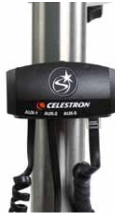
Die Interface-Box, montiert an einem Stativbein. Die Kabel von links nach rechts: AUX-1: StarSense-Kamera; AUX-2: StarSense-Handcontroller; AUX-3: Für SkySync GPS-Modul, hier unbesetzt. Ganz rechts das Verbindungskabel zur Montierung.
