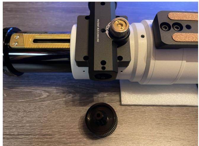
3. Kleinste Kupplung aus dem ZWO EAF Lieferumfang nehmen, aufstecken und bis zur Service Öffnung einschieben. Anziehen, dann langsam drehen bis die zweite Madenschraube über die Öffnung erreicht werden kann und nochmal anziehen.
