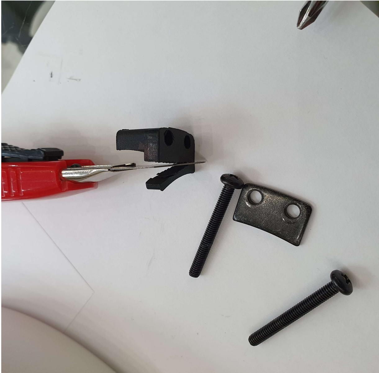
Den Gummipuffer unter die Löcher stellen und mit den Schrauben nur locker an die Zelle schrauben, so dass die anderen Klammern auch unter den Blendenring geschoben und mit Schrauben versehen werden können. Der Gummipuffer soll schützend zwischen Blendenring und Spiegel zu liegen kommen. Die kleinen Metallplättchen bleiben draußen.
