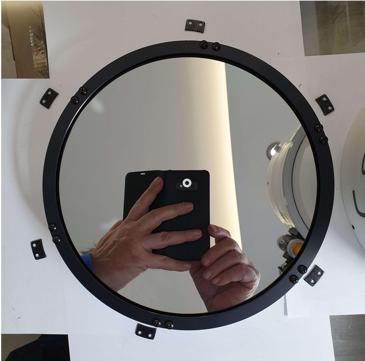
Drehen Sie schließlich die Schrauben so weit hinein, dass sie den auf den Gummipuffern liegenden Blendenring gerade berühren. Es darf auf keinen Fall Druck ausgeübt werden, sonst wird der Spiegel in seiner Form beeinträchtigt und die Abbildung leidet. Der Gummipuffer muss sich leicht bewegen lassen. Sie können die Schrauben optional sowohl unten am Gewinde als auch oben am Blendenring mit einem kleinen Klebepunkt fixieren.
