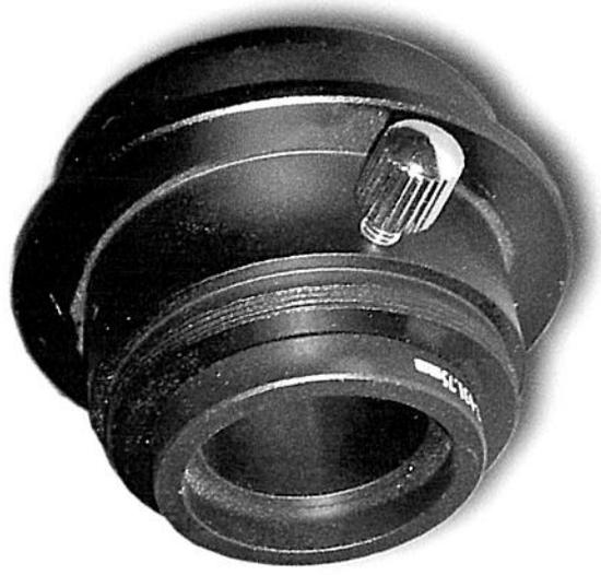
Adapter für die Mikroskopkamera (MicroQ) in den Grundadapter einschieben und mit Klemmschrauben befestigen
