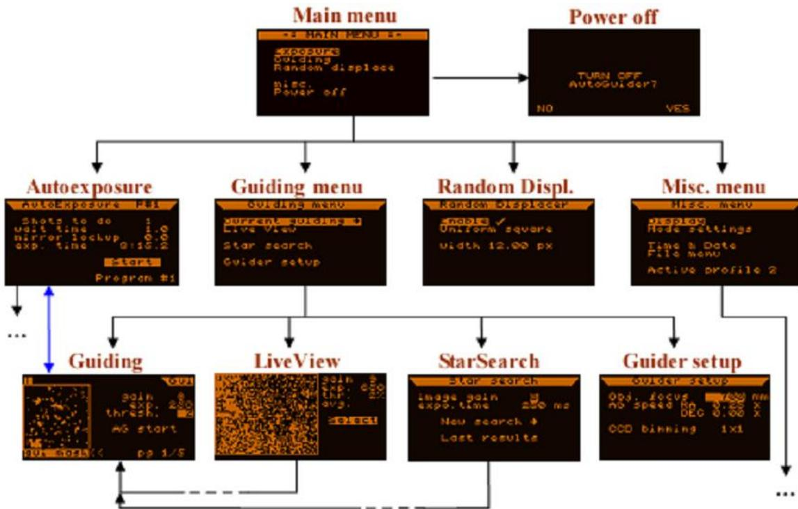
Um zwischen den Bildschirmen zu navigieren, verwenden Sie die SET und ESC Tasten. SET um ein Submenü zu erreichen, ESC um ein Submenü zu verlassen. Die vorangegangenen Menüs werden gespeichert, sodass beim Zurückgehen automatisch die ausgewählten Einträge wieder erreicht werden. Wird ein neues Submenü betreten, ist immer der voreingestellte Punkt ausgewählt.
