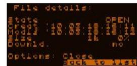
Zum Hauptmenü kommt man durch Drücken von ESC oder das Auswählen und Bestätigen des "Back to list" Eintrags. Auch nach einer "Open" oder "Close" Operation springt der MGEN automatisch wieder in die übergeordnete Fileliste..
