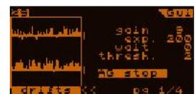
ein Pixel horizontal, während vertikal die Driften zum Toleranzlimit skaliert sind. Diese Toleranz wird rechts vom Fenster mit zwei kurzen Strichen angezeigt, in der Grösse von  $\pm 2$  Pixels zum Nullpunkt.
