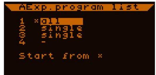
Ab FW. 2.03 gibt es 4 individuelle Belichtungsprogramme (unter 2.03 gab es nur eines). Jedes hat seine kompletten Einstellungsmöglichkeiten, wie 'shots to do', 'wait time' etc. Der Ablaufmodus wird für jedes Programm hier angezeigt, und kann per LINKS/RECHTS umgeschaltet werden. Die Modi bestimmen auf welche Weise ein Programm abläuft wenn mehrere Programme kombiniert werden.
