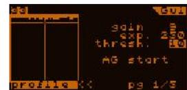
Bem.: Dieses Diagramm ist NICHT ein Histogramm, sondern eine "vertikal projizierte Karte" des Rohbildes. Damit kann der Fokus sehr fein eingestellt werden. Zeigt das Diagramm einen "Buckel", so ist der Stern schlecht fokussiert. Der Fokus ist am besten, wenn der "Buckel" an schmalsten und die Seiten am steilsten sind.
