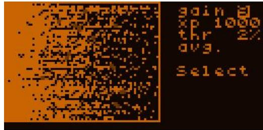
Jedes Pixel hier entspricht 10x10 Pixeln auf dem CCD-Chip, die Helligkeit ist von daher abgeleitet. Wie die Helligkeit genau bestimmt wird, darüber später mehr.
