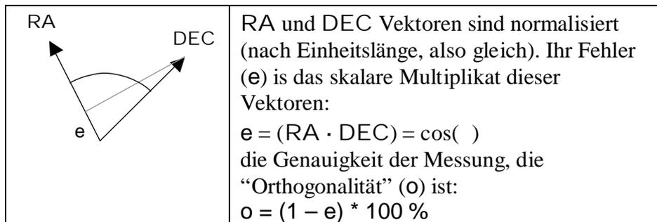
Nach erfolgter Kalibration wird der  $o$  Wert als "Orthogonalität" in Prozent angezeigt. Beträgt er 100%, dann ist die Orthogonalität perfekt.
