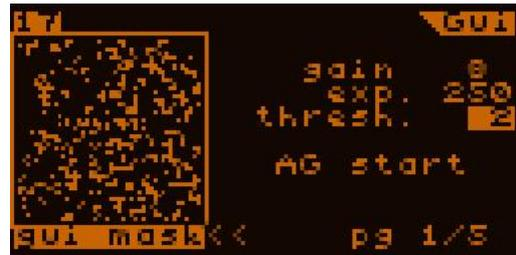
Auf allen 4 Unteranzeigen befindet sich links das Fenster mit dem 48x48 Pixel Bild des Leitsternes oder anderen Inhalts.
