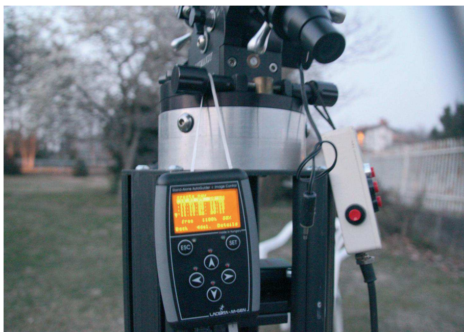
Sotto (vedi anche la foto alla pagina 52 in basso). La camera è fornita completa della "testa", dell'unità centrale – caratterizzata da un ampio display retroilluminato di colore arancione, e dalla caveria di collegamento (cavo RJ45, ST4 e mini-USB).
